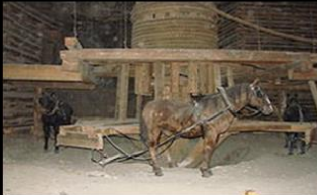
Колело и ос, задвижвани с коне, за извличане на дошита сол от вертикална шахта в солната мина Величка - Полша
