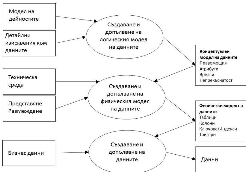
Фиг. 3. Процес на създаване на модел на данни [West, 2011]
