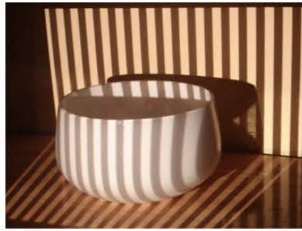
Фигура 2. Постановка на прожектиране на светлинна схема върху кръгла ваза
