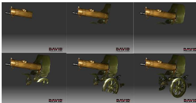
Фигура 4. Пример за изграждане на 3D модел на картучница „Schwarz-loze“.
