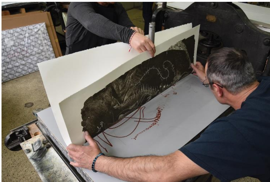
Фиг. 2. Процес на отпечатване от алуминиева форма за офсетов печат, чрез литографска технология.
