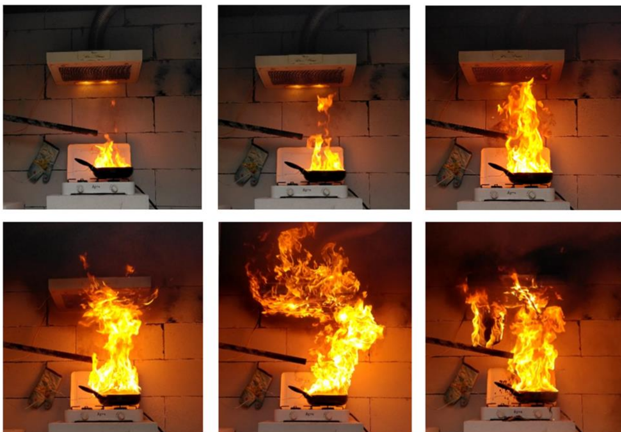
Фиг. 3 Демонстрация на развитието на пожар в готварски съд с мазнина
