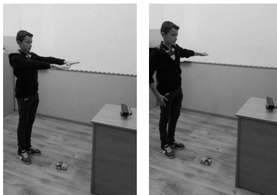
Фиг. 4. Управление на Капо робот чрез жестове, улавяни от Kinect
